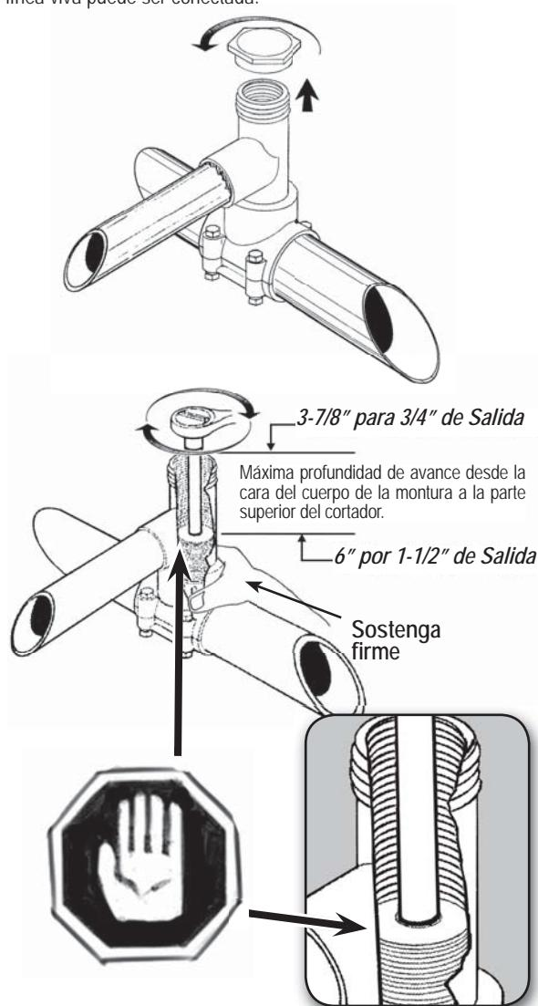
Una resistencia se producirá cuando la cuchilla haga contacto con la tubería. Continúe hasta que la resistencia disminuya, esto indicará que la cuchilla ha cortado a través de la tubería.
